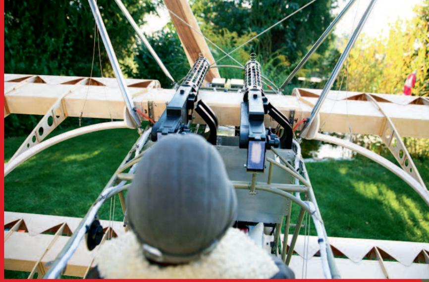
Das Cockpit sollte dem Modell qualitativ in nichts nachstehen. Funktionsfähiger und kardanisch aufgehängter Kompass, Steuerknüppel, Benzinregler, MGs – alles vom Feinsten!
